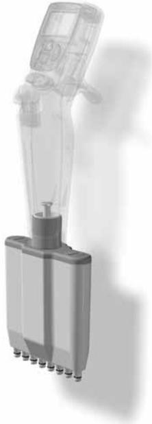
La partie basse visible sur l'illustration à gauche de la pipette ErgoOne® E Multicanaux est autoclavable à 121 °C (250 °F), 2 bar et un temps de maintien d'au moins 15 minutes selon DIN EN 285.
