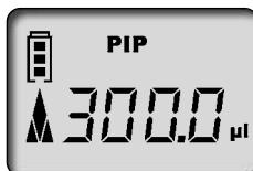
Das Nennvolumen bzw. zu prüfendes Volumen ist eingestellt, Standard-Modus Pipettieren (PIP), z. B. 200,0 µl (Vorgehensweise siehe PIP-Modus). Bsp.: Volumen entsprechend Volumenprüfung 301,3 µl.
