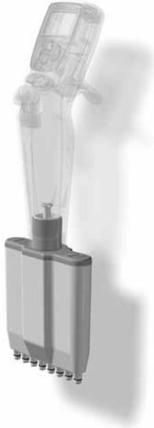
Der hervorgehoben abgebildete Teil der ErgoOne® E Mehrkanal-Pipette ist autoklavierbar bei 121 °C (250 °F), 2 bar und einer Haltezeit von mindestens 15 Minuten nach DIN EN 285.
