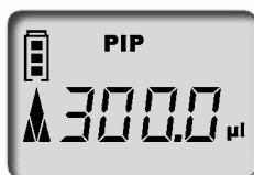
Après l'insertion d'une batterie, l'affichage de la pleine capacité apparaît à l'écran avec un cadre clignotant (l'appareil ne reconnaît pas encore l'état de charge dans un premier temps). Après 3,5 h de charge - charge complète de la batterie en toute sécurité - le cadre cesse de clignoter.
