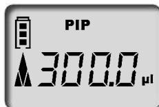
Al colocar la batería, la pantalla le mostrará el indicador de batería lleno con marco parpadeante (el equipo aún no reconoce el estado de carga). Luego de 3,5 h de carga (carga completa y segura de la batería), el marco dejará de parpadear.
