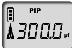
Nach dem Einsetzen eines Akkus erscheint im Display die volle Kapazitätsanzeige mit blinkendem Rahmen (das Gerät erkennt den Ladezustand zunächst noch nicht). Nach 3,5 h Ladezeit – sicheres vollständiges Laden des Akkus – hört der Rahmen auf zu blinken.
