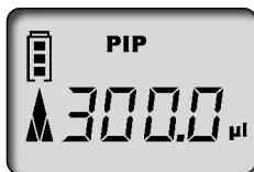
Il volume nominale o uno specifico volume da controllare è impostato, nella modalità standard Pipettaggio (PIP), ad es. 200,0  $\mu$ l (per la procedura vedere Modalità PIP). Esempio: Volume corrispondente alla verifica del volume 301,3  $\mu$ l.
