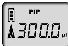
Le volume nominal ou le volume à contrôler est réglé, mode standard Pipetage (PIP), par exemple 200,0 µl (pour la procédure, voir Mode PIP). Ex. : Volume correspondant au test de volume 301,3 µl.
