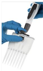
Gerät über einen geeigneten Entsorgungsbehälter halten und den Abwerfer bis zum Anschlag drücken.
