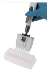
Am Ende der Absaugung Schlauch leersaugen und ggf. mit Reinigungs- oder Desinfektionsmittel spülen (durchsaugen). Ggf. Reagenzreservoir / Schale für Desinfektionsmittel (im Lieferumfang enthalten) verwenden.
