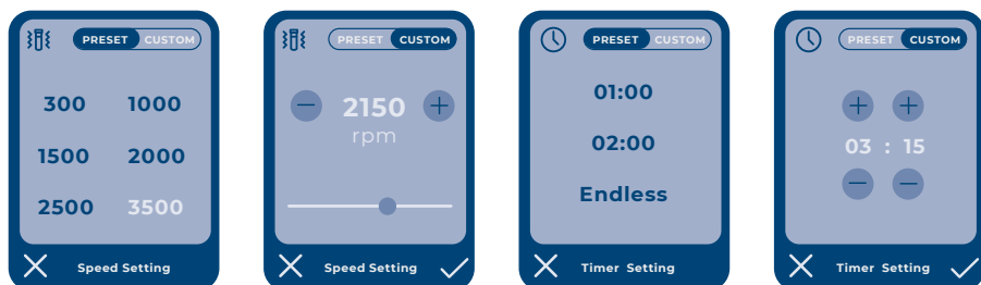
Fig. 5 Impostazioni predefinite e personalizzate della velocità e della durata (con accessorio standard installato)
