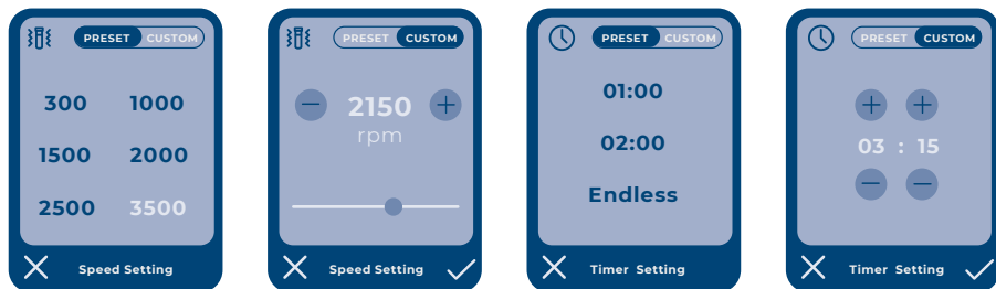
Fig. 5 Réglages de la vitesse et de la durée préréglés et personnalisés (avec le support standard installé)
